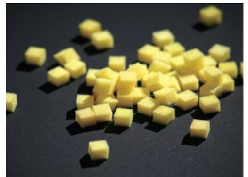
主材質がエーテル系ポリウレタンの為、親水性生物親和性が強く、高濃度に微生物を固定できます。また従来の物より比表面積が大きくなります。
