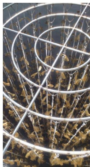
形状・サイズは直径12ミクロンの極細フィラメントが、ひと束で7万本の束です。微生物の付き方は複雑・強固に絡まり合った、ボール状の巣です。
